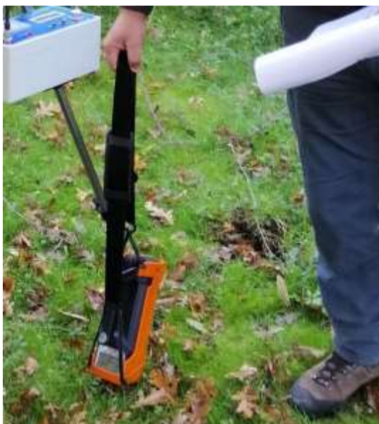
Figura 5 – Técnica de medição da radiometria de superfície com apoio em espectrómetro de raios gama (RS-230) – exemplo retirado da fototeca do LRN-UC.
