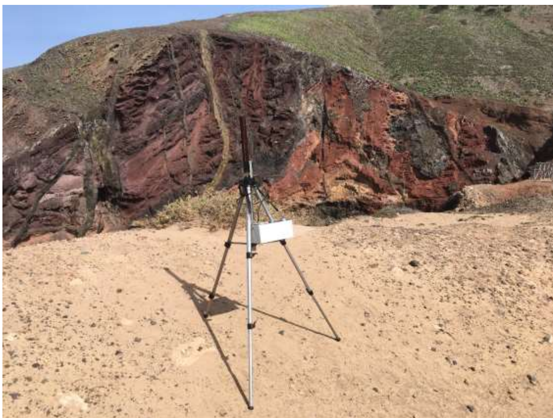
Figura 9 – Técnica de medição da radiação ambiente através da taxa de débito de dose por exposição à radiação gama (detetor Geiger-Muller ).
