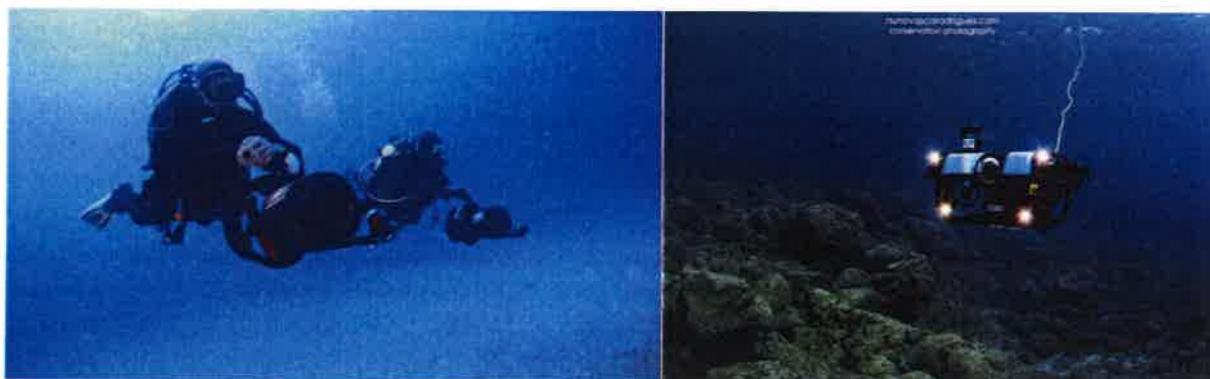
**Figura 2:** Operações de recolha de vídeo-transectos por mergulhadores com veículos de propulsão (esquerda) e Veículo Operado Remotamente (direita) equipados com sensores e câmaras de vídeo.
