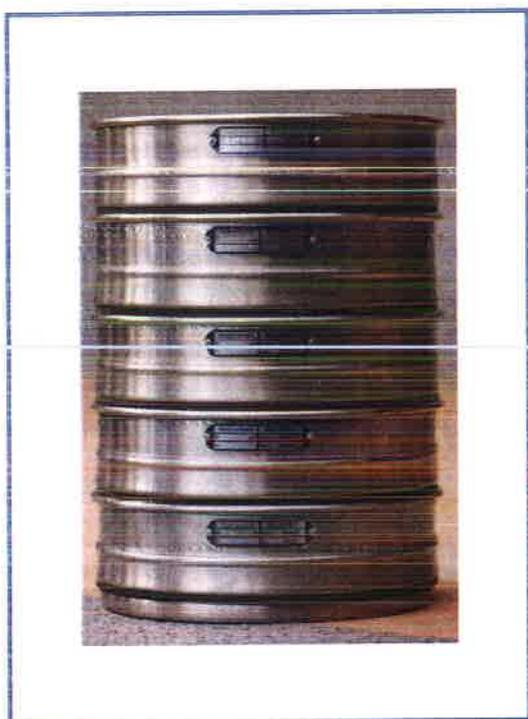
**Fig.4** – Crivos ordenados de forma decrescente em relação às dimensões da malha (1,40 mm, 710 $\mu$ m, 500 $\mu$ m, 355 $\mu$ m e 180 $\mu$ m respetivamente).
